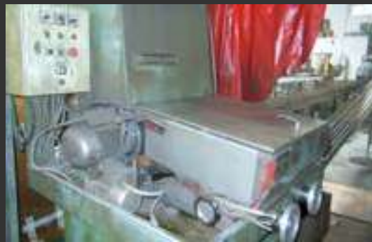
PROCESO RECTIFICADO MATERIA PRIMA: Elimina cualquier imperfección del tubo. Especialmente el carbono que queda en la superficie. Garantiza un perfecto acabado de la pieza. GRINDING PROCESS FOR RAW MATERIAL: Reduce any surface imperfections, specially the remains of carbon particles. Ensuring a smooth finish.
