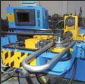
CURVADORAS AUTOMÁTICAS: Para fabricación de piezas en serie. AUTOMATIC BENDING MACHINE: For serial production.
