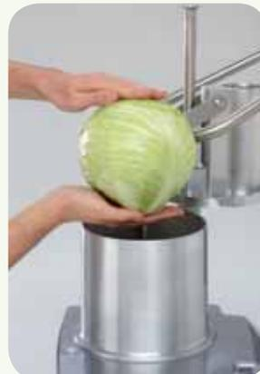
Palanca con movimiento asistido para reducir el esfuerzo del operario y ofrecer un mayor rendimiento.
