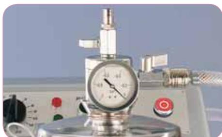
El dispositivo **R-VAC**, incorporado a los modelos R8 y R10, permite realizar preparaciones al vacío, para obtener resultados de una calidad incomparable en todo tipo de preparaciones tales como mousses de pescado, rellenos finos, terrinas de verduras, foie, cremas, etc.:
