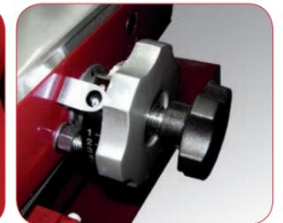
Regulador del espesor del corte de alta precisión.
