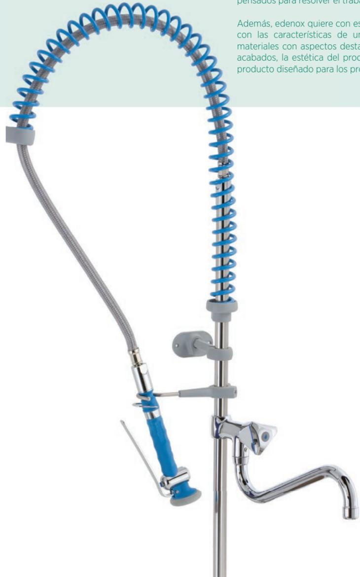
Muelle de acero con recubrimiento externo de pintura epoxi azul, mantiene sus características de anticorrosión y estabilidad en el tiempo. Terminales para el muelle en plástico conforme a normas. Soporte de pared de nylon con fibra de vidrio y latón.
